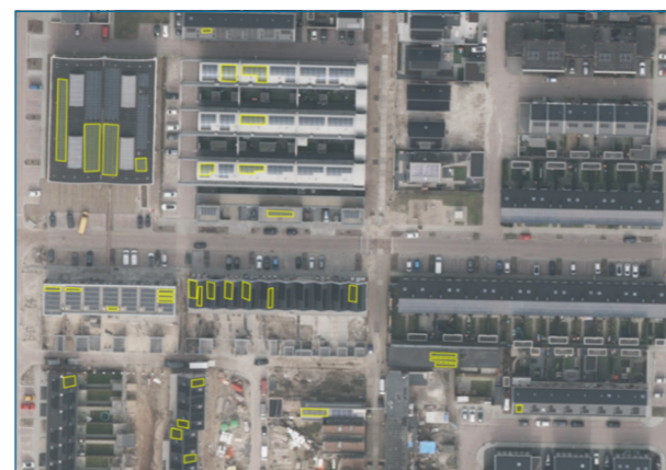
Een voorbeeld van automatische mutatiedetectie op basis van luchtfoto's, waarbij door beeldherkenning kan worden gezien waar zonnepanelen zijn aangebracht. (Foto afkomstig uit de Label Object for Deep learning tool in ArcGIS Pro).
